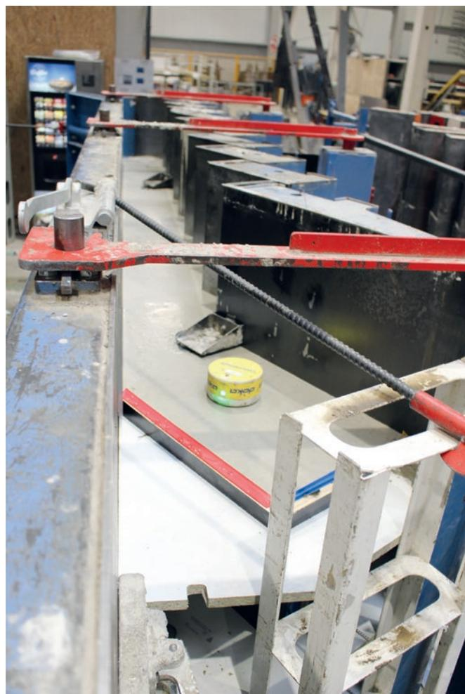
*Alle Treppenschalungen werden stehend befüllt, sodass nur die wandseitige Treppenwanne nicht schalungsglatt ist. Auch hier wird mit einem Beton-Monitoring von Concremate/Doka gearbeitet, um ideale Taktzeiten zu erzielen.*
