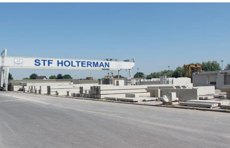
Der Lagerplatz der STF Holterman. Ca. 70 % der Betonfertigteile werden in SVB hergestellt.
