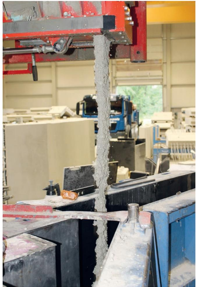
*Der SVB der Druckfestigkeitsklasse C 45/55 ist sehr stabil und fließt bis in die letzte Ecke der Schalung. Der Betonierkübel muss während der Betonage folglich nicht verfahren werden.*
