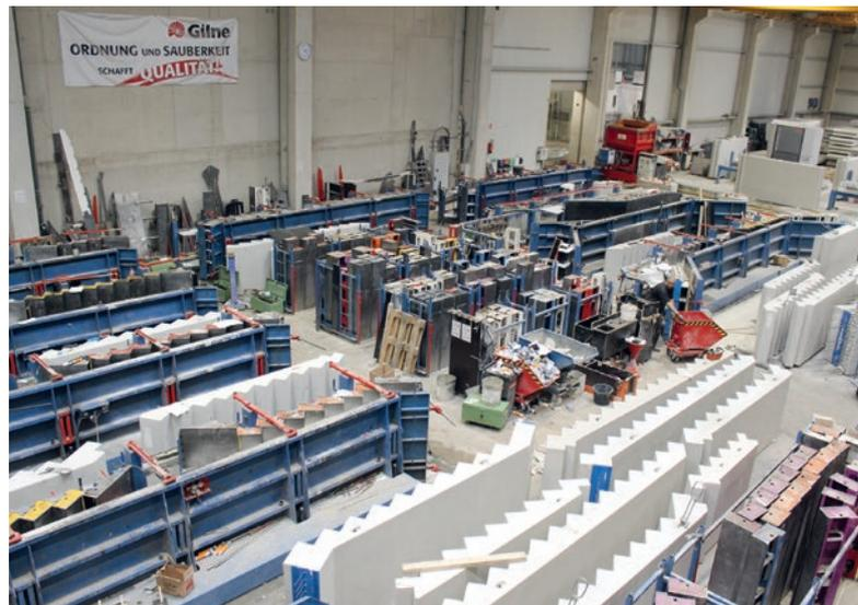
*Die seit 2019 in Betrieb befindliche Werkshalle in Uffeln. Gilne produziert hier ausschließlich mit SVB. Die Auslastung der Formen ist bei nahezu 100 % im Zweischichtbetrieb.*
