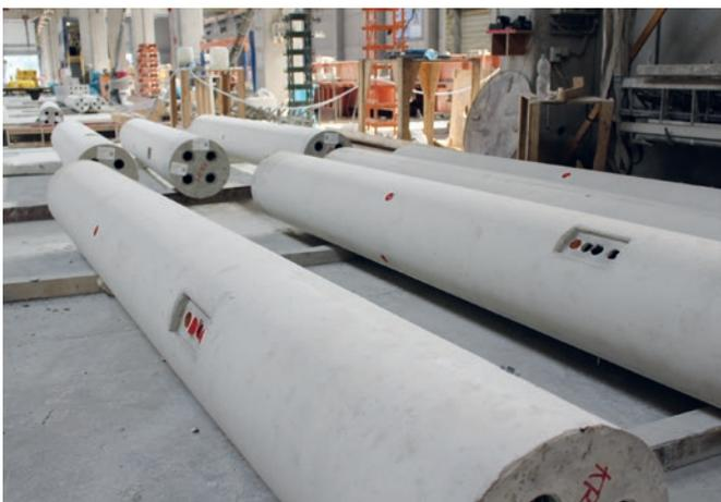
*Stützenformen mit einer Höhe von bis zu fünf Metern. Üblicherweise wird bei SFT Holterman ein SVB der Druckfestigkeitsklasse C 55/67 hergestellt. Die hochwertige Oberfläche und die sehr gute Qualität in Bezug auf die Dauerhaftigkeit sind schlagkräftige Argumente für den Einsatz von SVB.*
